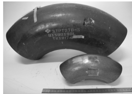
図11 試験に用いた配管エルボサンプル(奥側:250A、手前側:100A)
